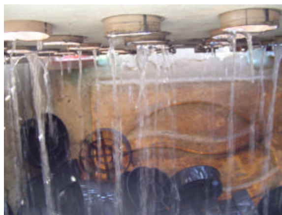
Figura 4.8 – Performance de molhamento da bandeja (utilizada na pesquisa)
