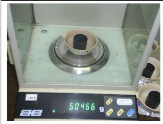
Figura 4.10a - Pesagem do Meio Suporte com biofilme aderido
