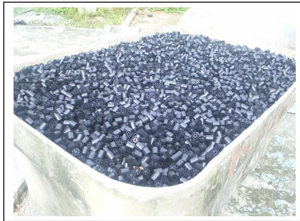
Figura 4.9b - Tanque de 1 m<sup>3</sup> preenchido com Meio Suporte
