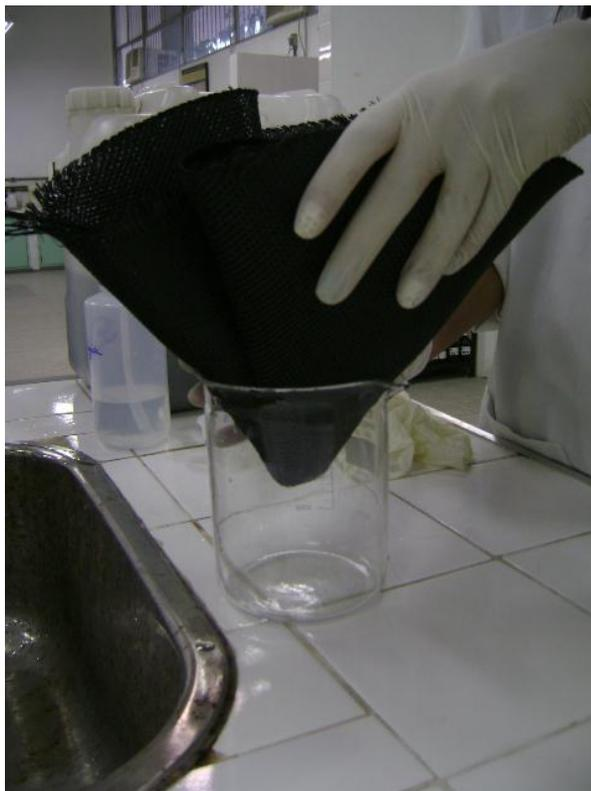
Figura 11: Cone teste (malha Geotube®) empregado
