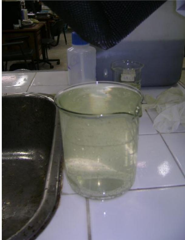
Figura 29: Efluente tratado em cone teste (malha Geotube®)
